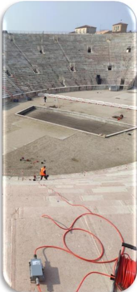
Arena di Verona: prospezioni sismiche per la caratterizzazione strutturale
