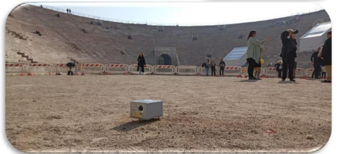
Arena di Verona: prospezioni sismiche per la caratterizzazione strutturale
