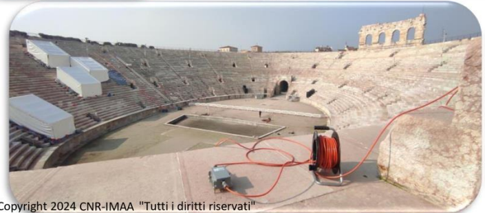
Arena di Verona: prospezioni sismiche per la caratterizzazione strutturale
